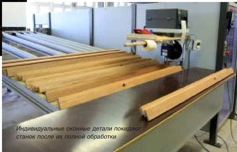
Обработывающий центр HOMAG powerProfiler для полной обработки оконных и дверных деталей и створок для входных дверей
